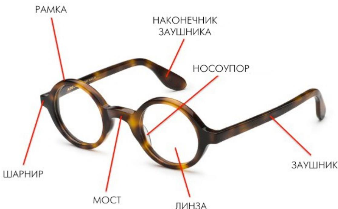
**Носоупоры** – приспособления, которые делают посадку очков на носу удобной. Они могут быть неподвижными и подвижными (крепятся к ободкам с помощью держателя).
